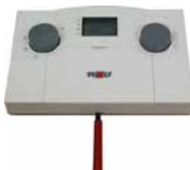
Desmontaje del ART de la base utilizando un destornillador
