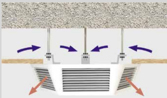
TLHD montado en un falso techo
