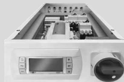
La regulación controlada por microprocesadores, incorporada (variante CRL evo max) o adosada (variante CRL) y cableada de fábrica con interruptor integrado en el equipo, controla y regula ventiladores, recuperación de calor, temperaturas, caudales volumétricos, tiempos de funcionamiento y numerosas funciones internas y de alarma.
