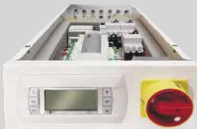
La regulación controlada por microprocesadores, montada y cableada de fábrica con seccionador integrado en el equipo, controla y regula ventiladores, recuperación de calor, temperaturas, caudales, tiempos de funcionamiento y numerosas funciones internas y de alarma.
