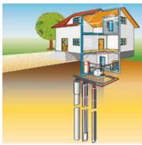
Esquema de la instalación – Sonda de tierra
