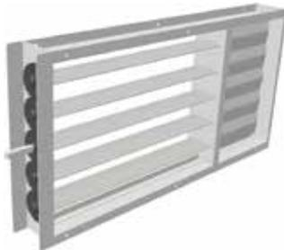
Comprobar el funcionamiento suave de las compuertas. No lubricar las compuertas. Esto podría inutilizar el plástico empleado y anular la función de la compuerta.
