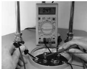
El ánodo de magnesio instalado puede descomponerse debido a reacciones electroquímicas ya que su función es preservar al acumulador de la corrosión. Por esta razón es preciso controlarlo y en su caso cambiarlo cada dos años.
