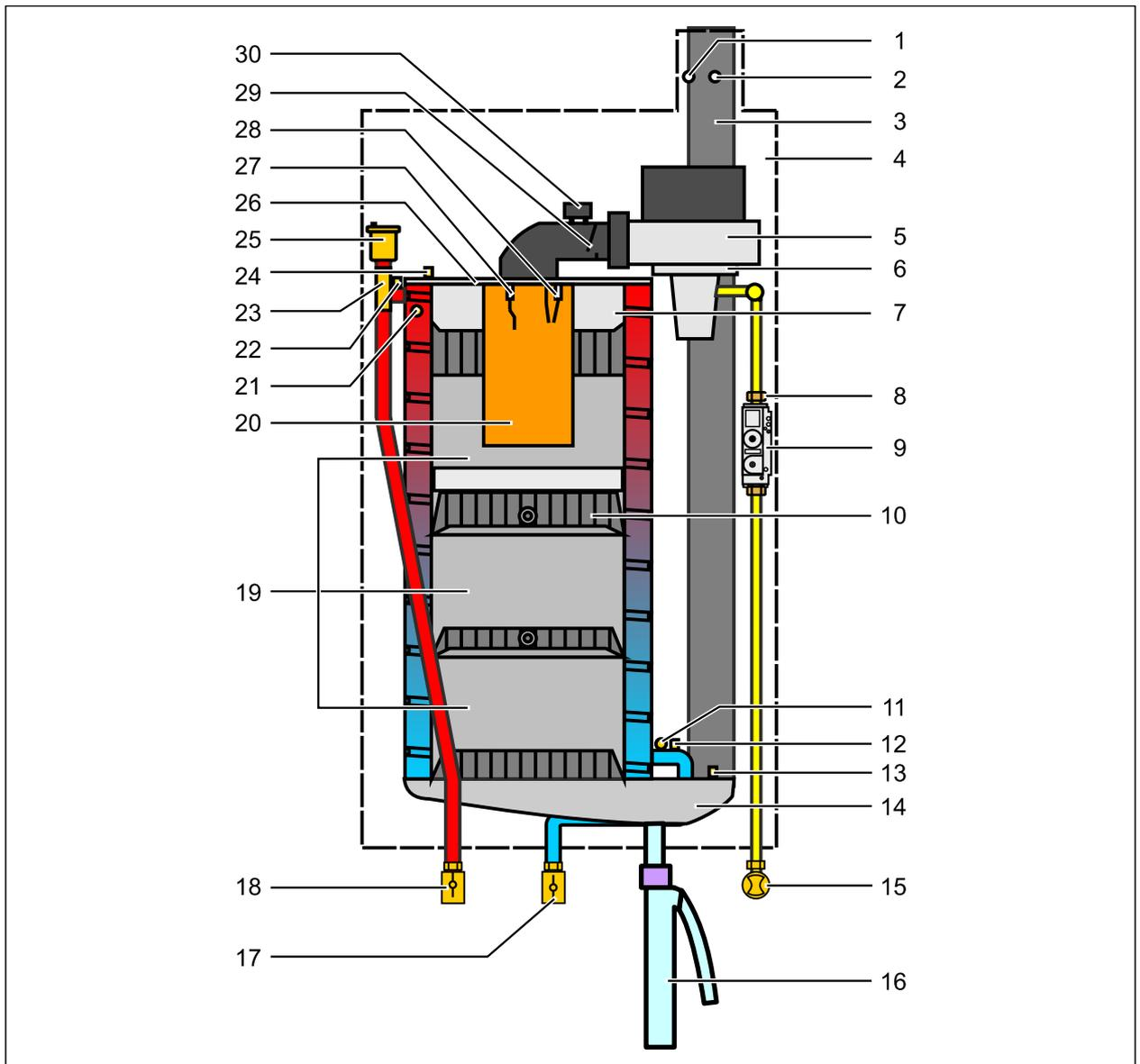
**Fig. 3.1 Esquema de componentes de la caldera de condensación a gas**
